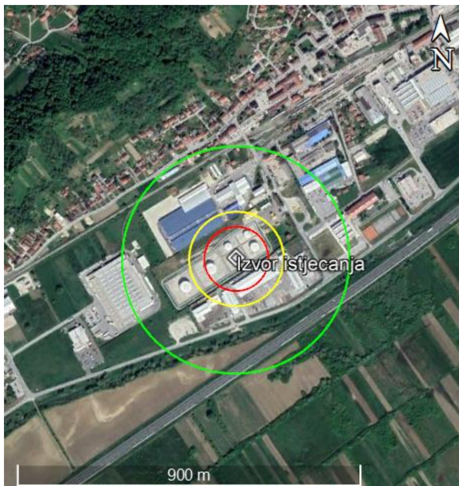
Slika 22. Zone ugroženosti uslijed disperzije plinske faze benzina (nakon izlijevanja benzina u tankvanu)
