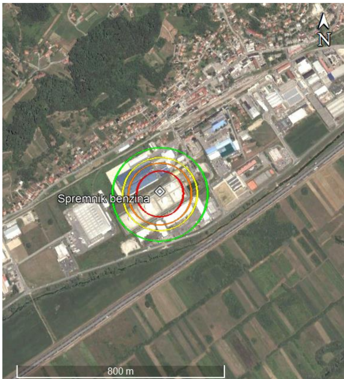
Slika 18. Zone utjecaja u slučaju kolapsa spremnika benzina i nastanka požara
