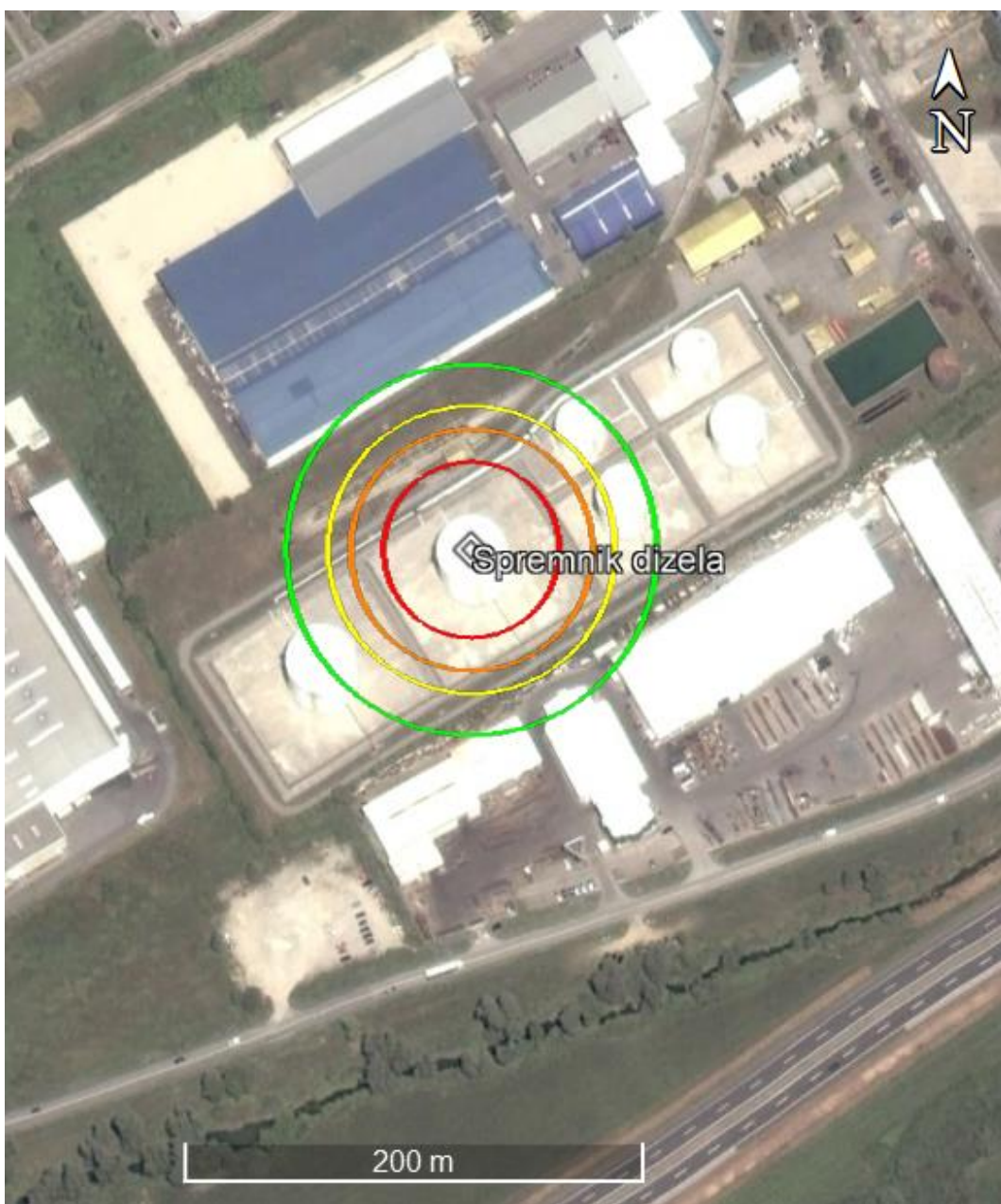
Slika 27.: Zone utjecaja u slučaju kolapsa spremnika dizela i nastanak požara
