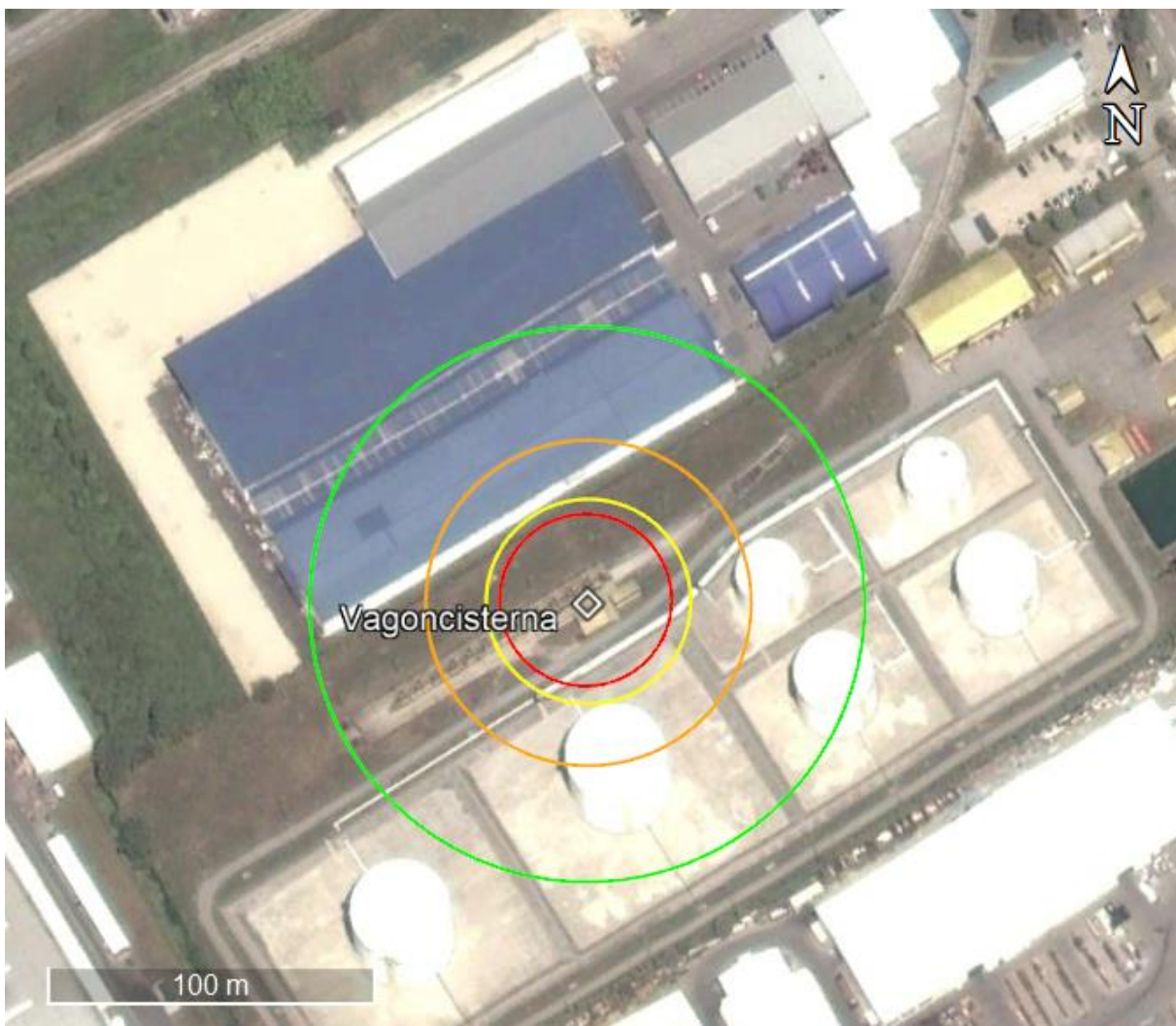
Slika 31.: Zone utjecaja u slučaju kolapsa vagoncisterne benzina i nastanka eksplozije
