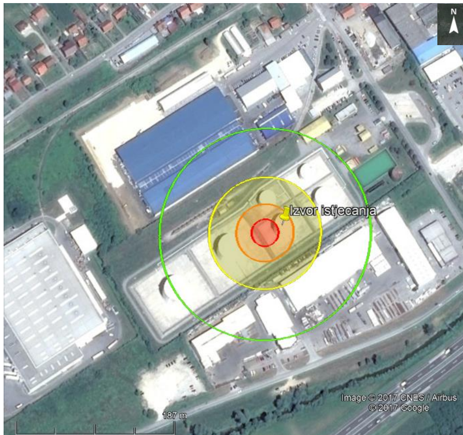
Slika 24. Zone ugroženosti uslijed eksplozije plinske benzina 30 minuta nakon istjecanja
