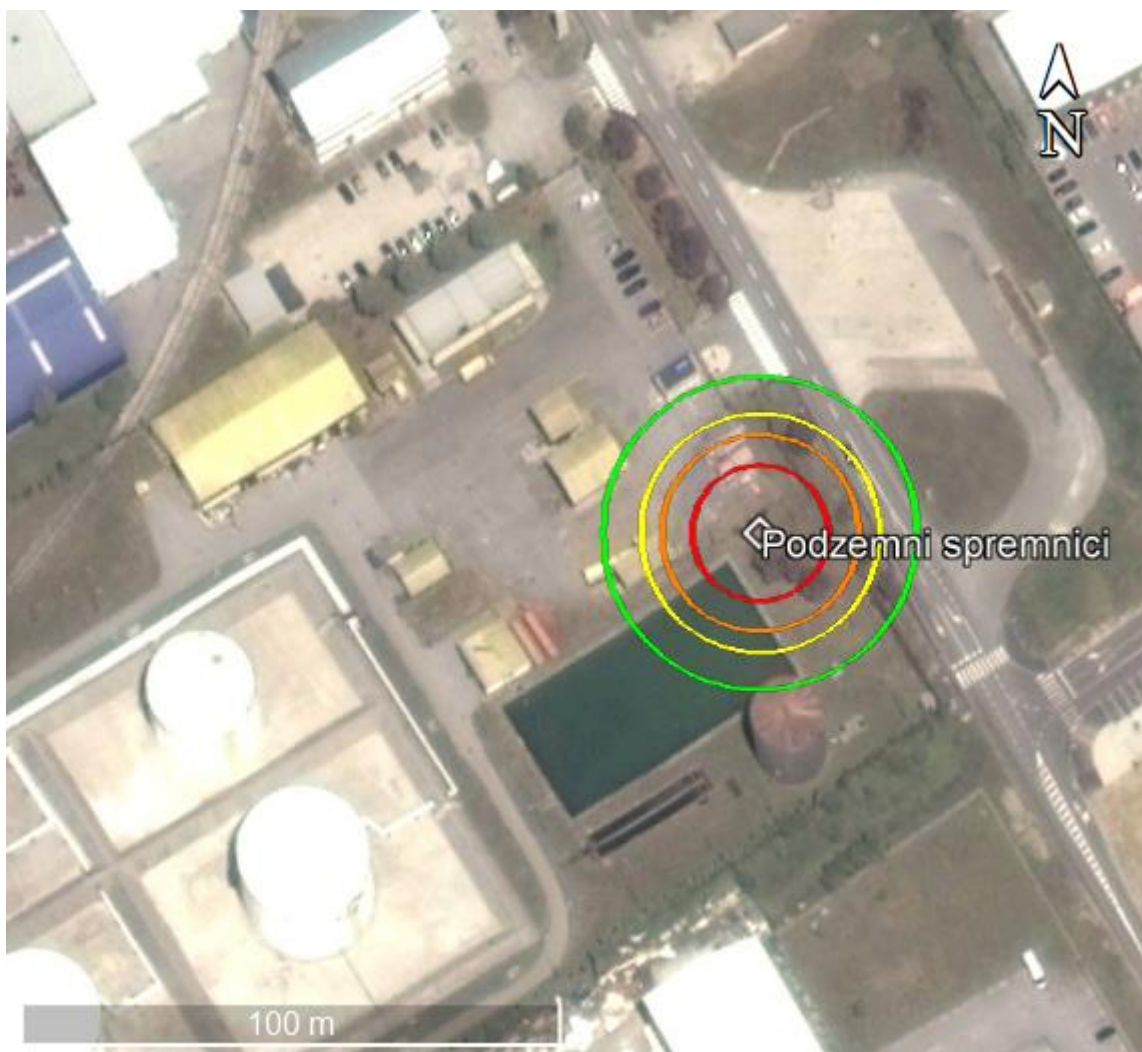
Slika 35. Zone utjecaja u slučaju kolapsa autocisterne dizela i nastanka požara
