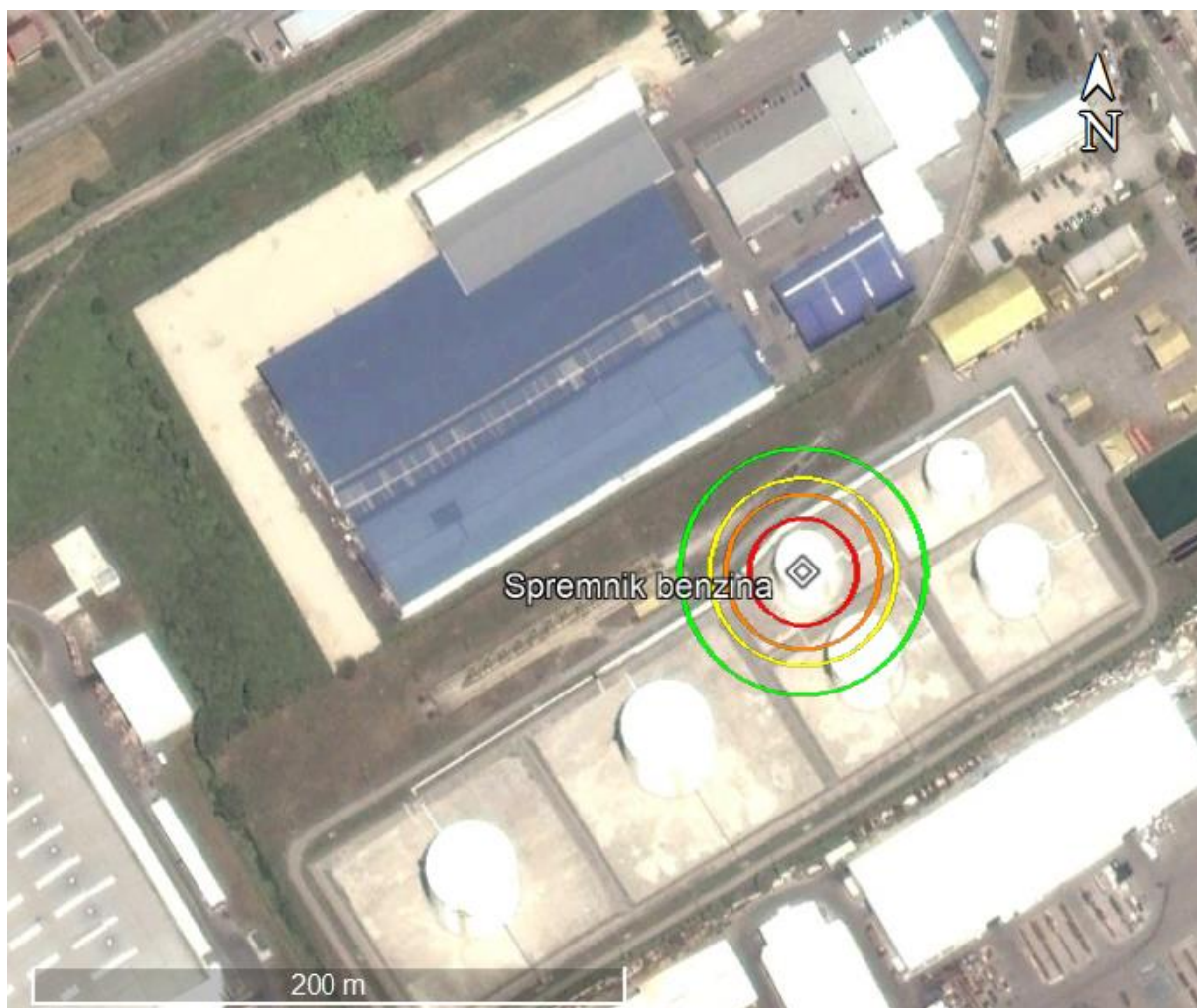
Slika 20. Zone utjecaja u slučaju kolapsa spremnika benzina i nastanka požara
