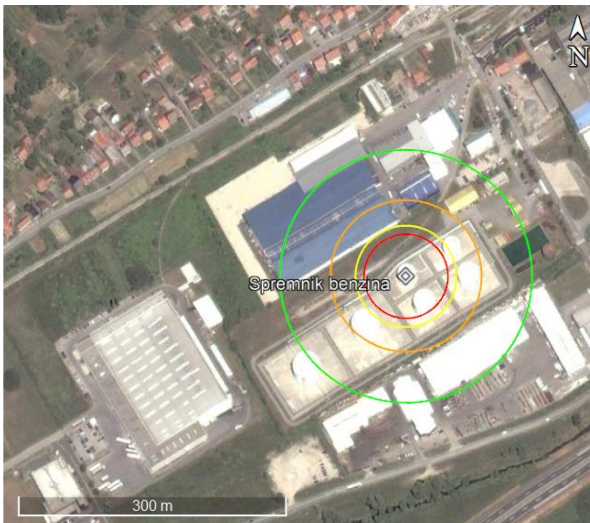
Slika 19.: Zone utjecaja u slučaju kolapsa spremnika benzina i nastanka eksplozije
