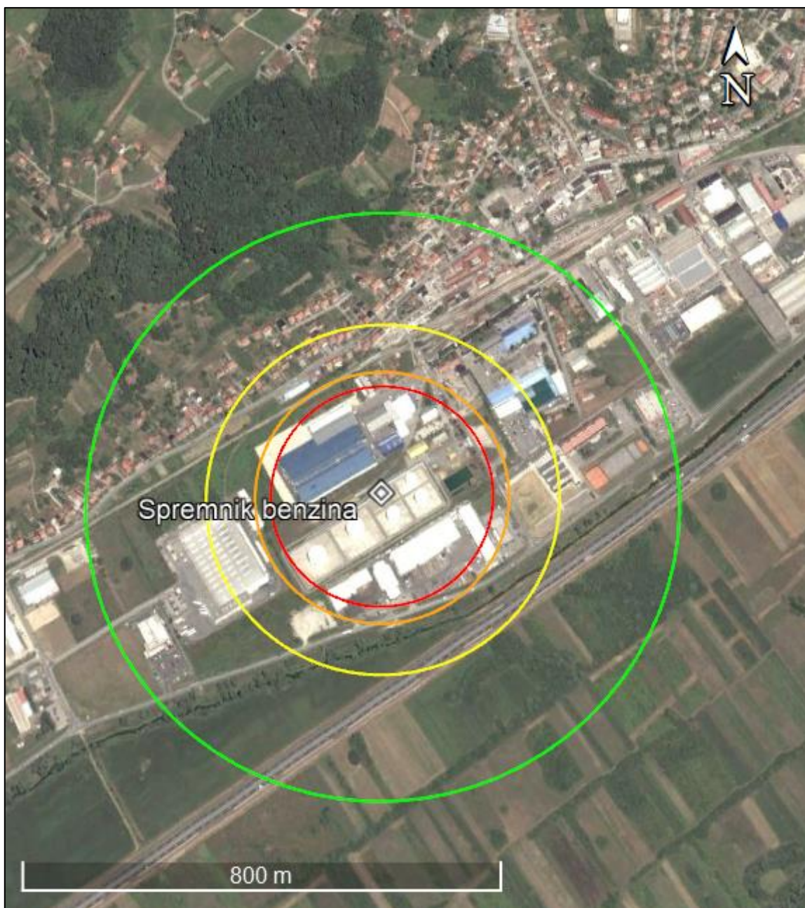
Slika 17.: Zone utjecaja u slučaju kolapsa spremnika benzina i nastanka eksplozije
