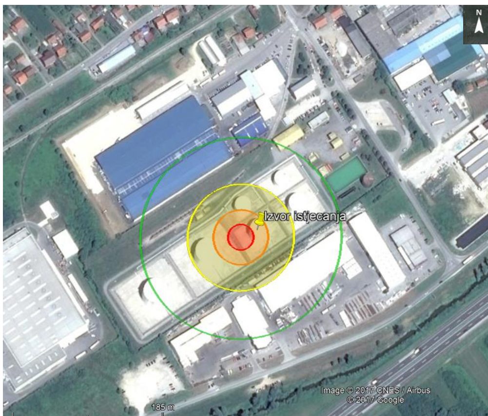
Slika 25. Zone ugroženosti uslijed eksplozije plinske benzina 60 minuta nakon istjecanja
